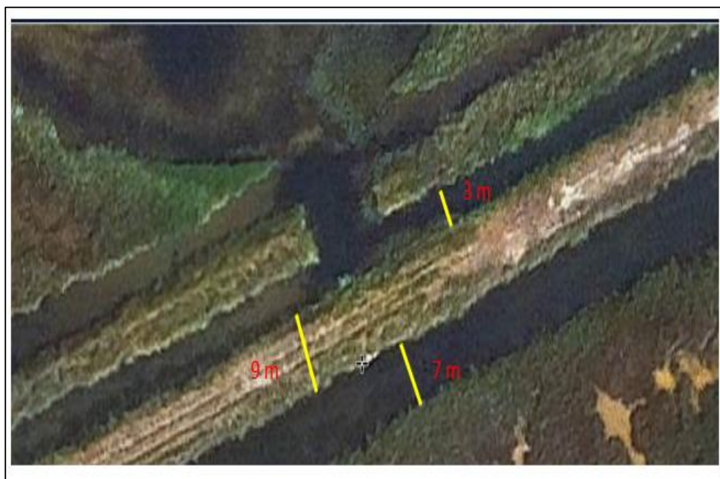
Figura n°10 Ortofotomapa amb la zona d'actuació i les amplades de dics i rases laterals.
