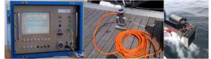
Central de recollida de dades (esquerra), cable i capçal d'adquisició previ a la seva instal·lació (centre) i capçal instal·lat al lateral del vaixell abans de ser submergit (dreta).
