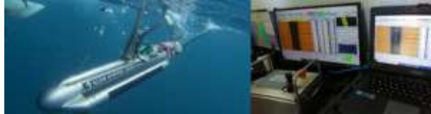
Sonar d'escombrada lateral submergit durant l'adquisició (esquerra) i central d'adquisició de dades a coberta (dreta)
