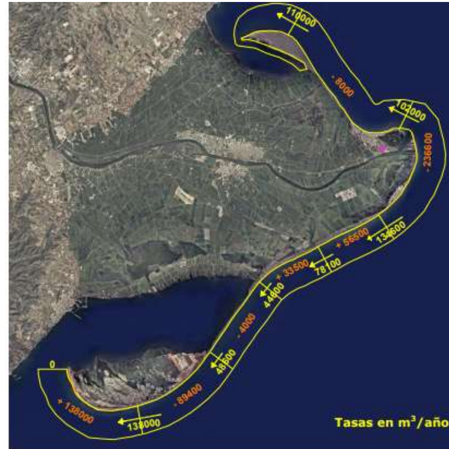
Figura 5.1.21. Balanç sedimentari per transport longitudinal de sediment.
